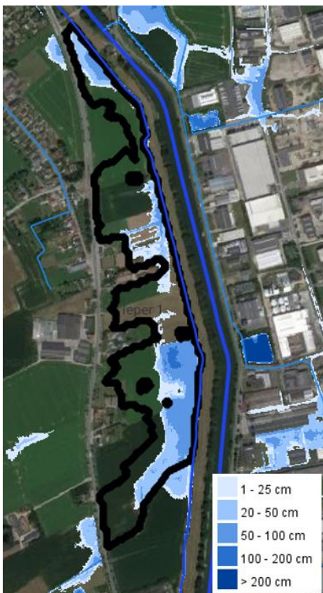
Figuur 111: Pluviale overstromingskaart (middelgrote kans van voorkomen, waterinfo.be) locatie 42 leper 1
